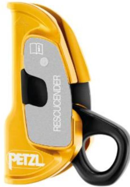
El **RESCUCENDER** es un bloqueador de leva ranurada con cierre destinado a ser utilizado en los polipastos como sistema de tracción o anti-rretorno. Está fabricado en aluminio, acero inoxidable y poliamida.
